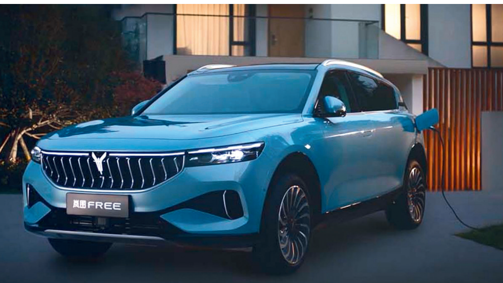
Bild 5. Der Frontgrill und die Nebelscheinwerferabdeckungen des Voyah Free SUV bestehen aus Luran S 778T SPF30 von Ineos Styrolution. © Voyah
